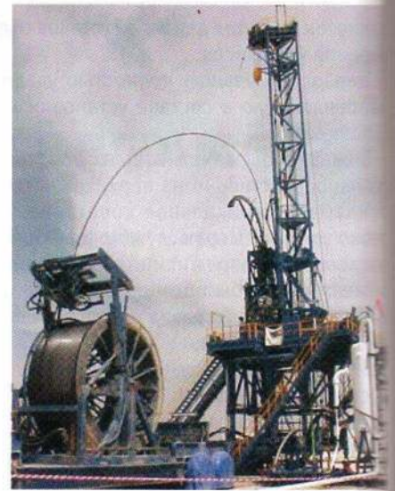
Рис. 5. Колтубинговая буровая установка «ВНІ» в Омане Fig. 5. Parabolic Arch — BHI CT Drilling Rig in Oman
