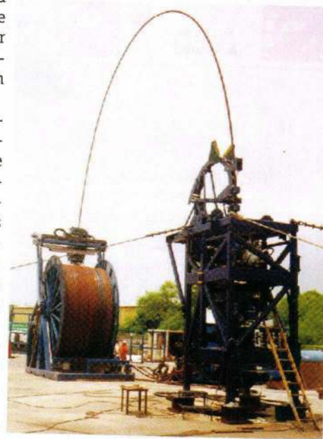
Рис. 3. Парабола свободной линии колтюбинга минимизирует усталостные повреждения
