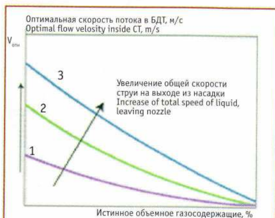
Рис. 5. График влияния газового содержания в промывочной жидкости на относительную скорость потока V_{\text{отн}} в колонне БДТ:
