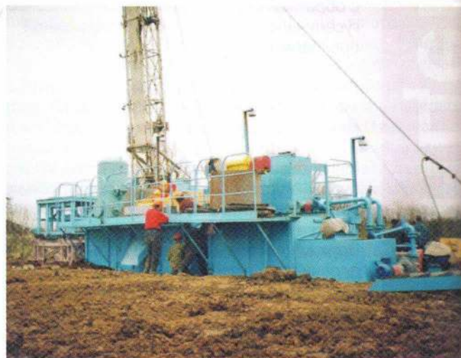
Рис. 1. Малогабаритная циркуляционная система объемом 30 м³ Fig. 1. Compact circulation system 30 m³.
