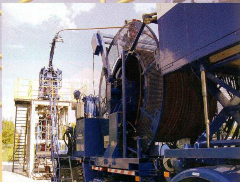
На фото: инжектор с тяговым усилием 24 т на испытательном стенде Фото предоставлены СЗАО «ФидМаш»
