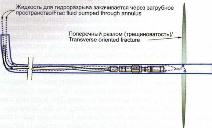
Рис. 7а. Интенсивность подачи через колтюбинговую трубу снижается, и КНБК поднимается выше по стволу скважины из перфорированного интервала после закачки наполнителя или перед тем, как высококонцентрированный расклинивающий наполнитель попадает в перфорацию. При низких интенсивностях колтюбинговая труба выступает в качестве натяжной колонны для точного наблюдения за давлением гидроразрыва, поглощение проводится после окончания каждой стадии гидроразрыва.
