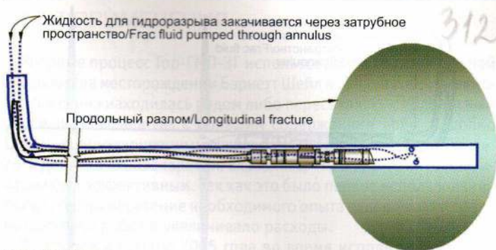
Жидкость для гидроразрыва закачивается через затрубное пространство/Frac fluid pumped through annulus Продольный разлом/Longitudinal fracture Рис. 7б. Образованные разломы могут быть продольными, а не поперечными по отношению к стволу, в зависимости от предпочтенной плоскости трещины в определенной точке коллектора. Fig. 7b. The fractures created could be longitudinal instead of transverse to the wellbore depending on the preferred fracture plane at the specific location in the reservoir.
