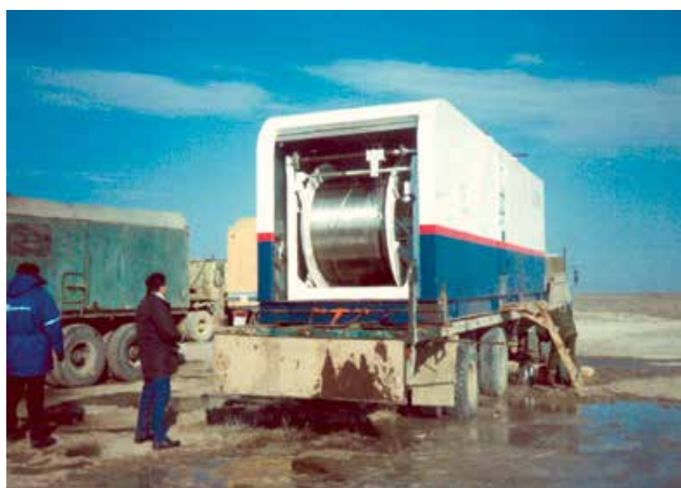
Рисунок 3 – Установка с гибкой трубой
