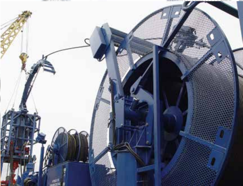
На фото: инжектор с тяговым усилием 27 т на испытательном стенде
