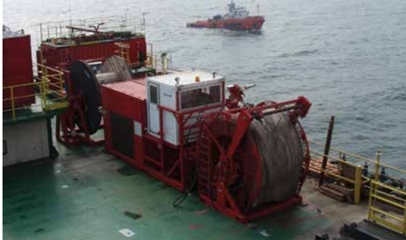
Coiled Tubing Unit M-30 for Offshore Operations, Delivered for LUKOIL Колтюбинговая установка М-30 на морской платформе, поставленная ОАО «ЛУКОЙЛ»
