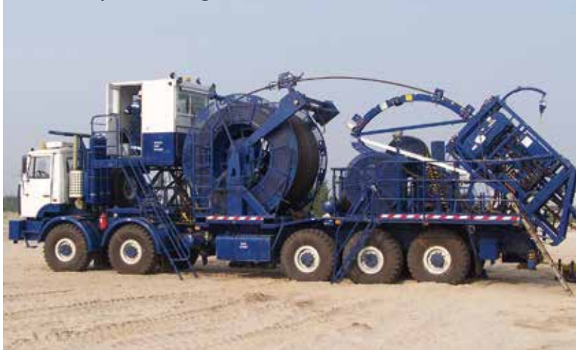
Coiled Tubing Unit M-20, Developed for Schlumberger Колтюбинговая установка М-20, разработанная по заказу Schlumberger
