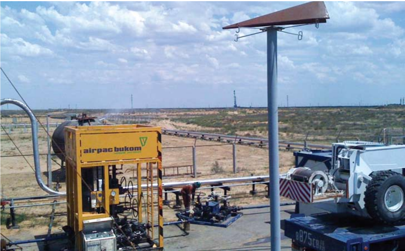
Рисунок 5 – Фильтрующая установка высокого давления и штуцерный манифольд Figure 5 – High pressure filters and choke manifold
