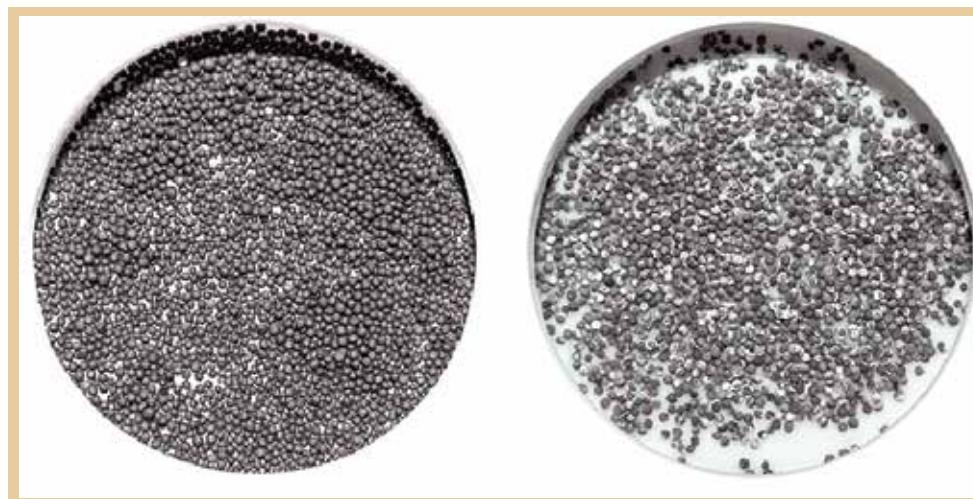
Рисунок 2 – Растворимость проппанта в грязевой кислоте при температуре 80 °C и выдержке 8 часов: а) проппант до исследования; б) проппант после исследования – видны следы вторичного осадкообразования – белый налет на проппанте
