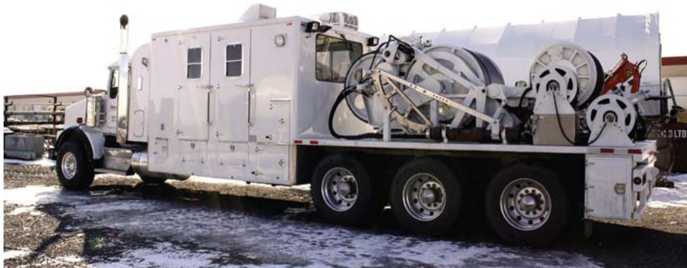
сравнению с вертикальным или горизонтальным методом и 2) процедура установки кабеля не уменьшает срок усталости гибкой трубы. При использовании данной системы кабель прокладывается быстро: средняя скорость 60 м/мин. Инжекторная система позволяет устанавливать не только стандартный каротажный кабель, но и кабель с пластмассовым покрытием, а также капиллярные трубы малого диаметра.
