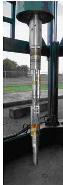
**Рисунок 2 – Призабойный инструмент, используемый в технологии ACTive\***
