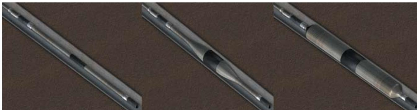
Рисунок 3 – CoilFLATE\* – наддувной пакер на ГНКТ (слева направо: спуск в скважину, процесс посадки пакера, полная посадка на ствол скважины)
