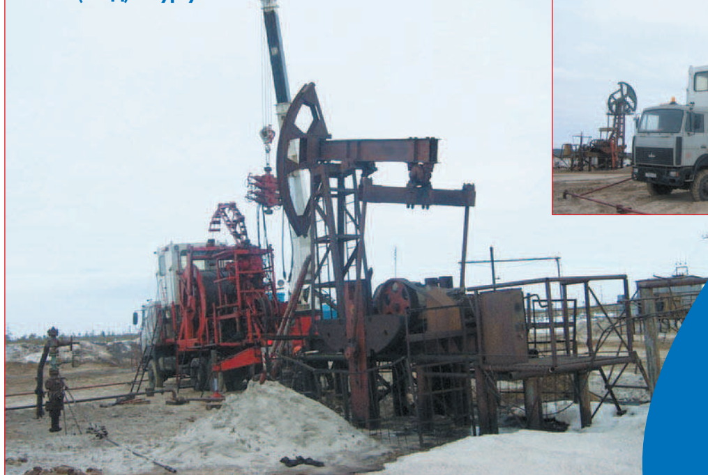
Колтюбинговая установка М1001 (ФИД) в Сургуте
