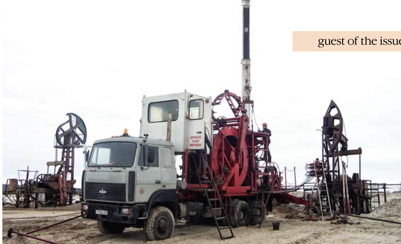
Колтюбинговая установка M10 M10 CT Unit
