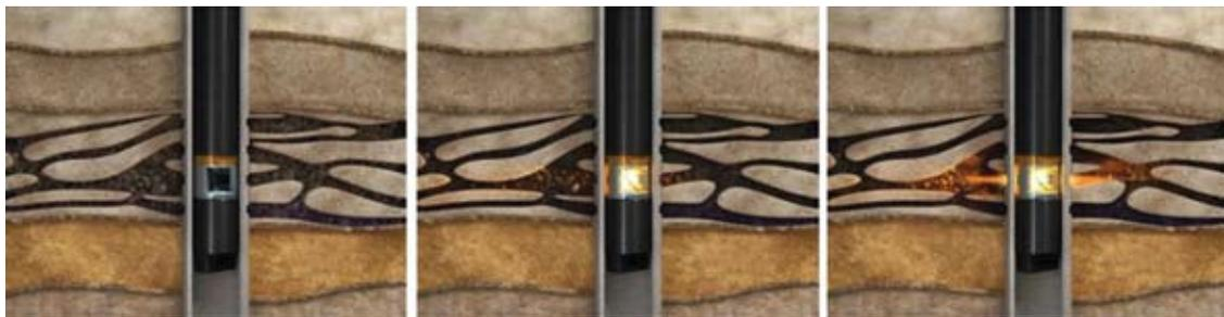
Излучатель, электроды замкнуты проводником, перфорационные каналы закольматированы.
