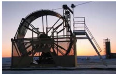
**Компактный измерительный кабель для каротажа**
