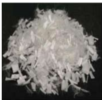
Рисунок 1 – Самораспадающиеся волокна J595 и вязкоупругая кислотная система VDA
