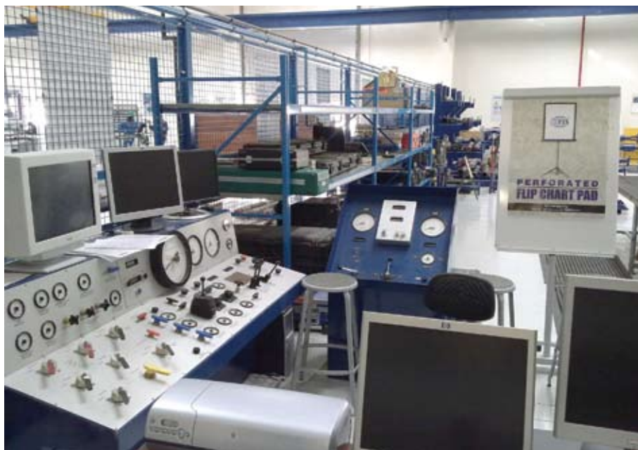
Рисунок 5 – Электронный симулятор подразделения ГНКТ Figure 5 – Electronic simulator of Coiled Tubing Services
