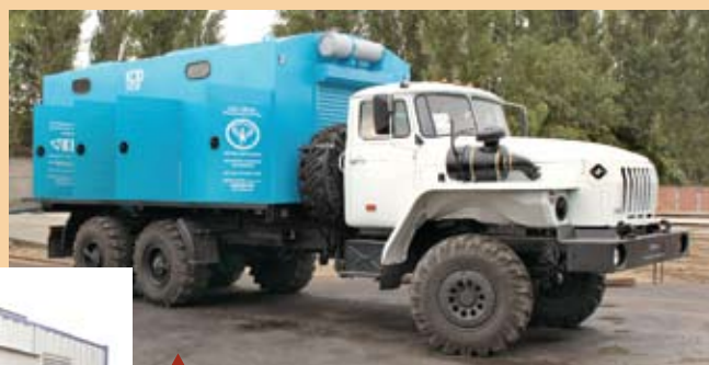
▲ ТГА 5/101 Б 95 на шасси УРАЛ Производительность – 5 м 3 /мин; Давление – 101 атм.; Чистота азота – 95%.
