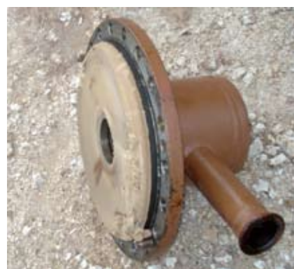
Рисунок 2 – Осадок с АГЗУ ДНС-38, Кумкольское месторождение ОА «Тургай Петролеум»
