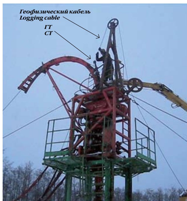
Рисунок 1 – Оснащение ГТ геофизическим кабелем с применением механизма заправки кабеля Figure 1 – Equipping the CT with a logging cable with the help of cable installation mechanism
