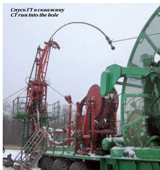
Рисунок 1 – Оснащение ГТ геофизическим кабелем с применением механизма заправки кабеля Figure 1 – Equipping the CT with a logging cable with the help of cable installation mechanism
