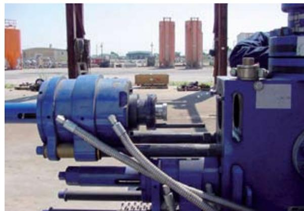
**Рисунок 4 – X-11\* ПВО открыт и готов к переборке плашек**
