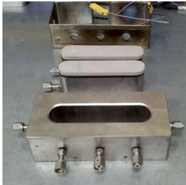
**Рисунок 2 – Внешний вид разобранной одиночной ячейки проводимости**
