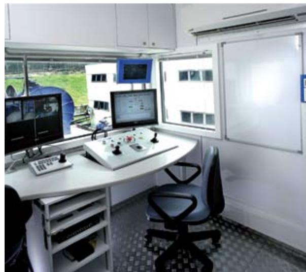
**Рисунок 2 – Сертифицированная Zone II кабина управления установки X-11\***
