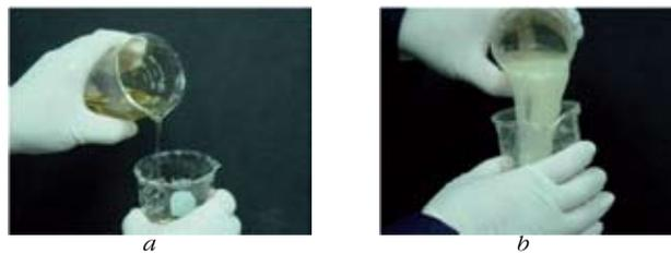
**Рисунок 2 – Изменение вязкости кислотной системы VDA\* при закачке в скважину (a) и в пласте при реагировании кислоты с породой (b)**
