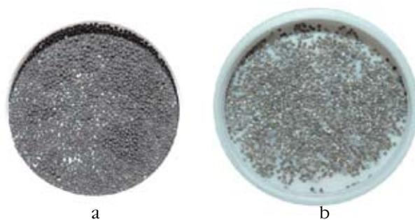
**Рисунок 4 – Проппант до (а) и после воздействия 12%-й соляной кислоты (б) при температуре 80 °С в недостатке кислоты – проппант смочен кислотой, видны белые вкрапления осадка**
