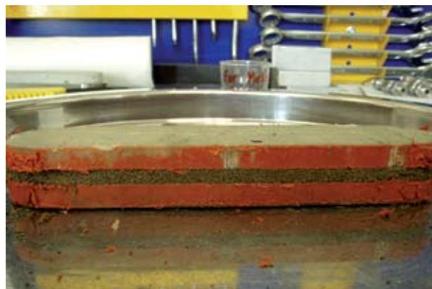
**Рисунок 3 – Пластины из натурального керна для исследования проводимости проппанта**
