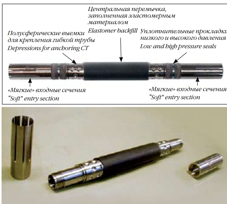
Рисунок 5 – Дизайн «высокопрочной» барабанной соединительной муфты
