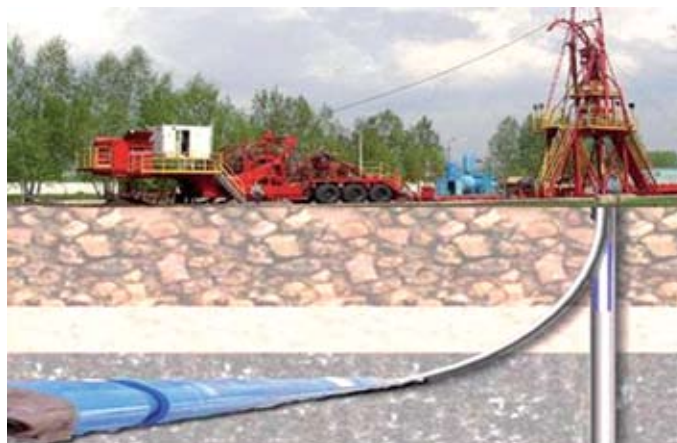
Рисунок 2 – Колтюбинговый комплекс для направленного бурения
