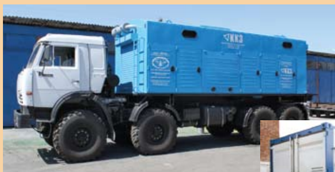
▲ ТГА 10/251 С 95 на шасси КАМАЗ 63501 Производительность – 5 м 3 /мин; Давление – 251 атм.; Чистота азота – 95%.
