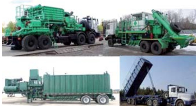
Рисунок 6 – Комплекс оборудования для ГРП
