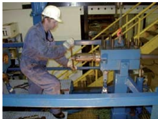
Рисунок 6 – Устранение внутреннего заусенца продольного сварного шва ГТ Figure 6 – Reaming of Internal Weld Flash of CT Longitudinal Weld Seam
