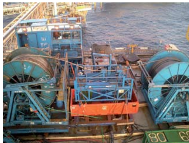
Рисунок 2 – Компоновка с ГТ для согласования кромок и установки соединительных муфт [1] Figure 2 – Assembly Skid for CT Connector End Preparation and Installation (Ref. 1)
