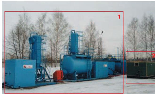
**Рис. 3. Закрытая циркуляционная система с насосным блоком**
