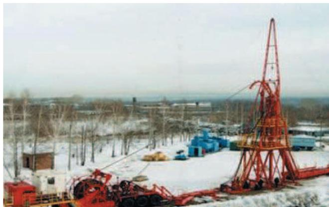
**Рис. 2. Комплекс для бурения на депрессии с использованием гибких труб**
