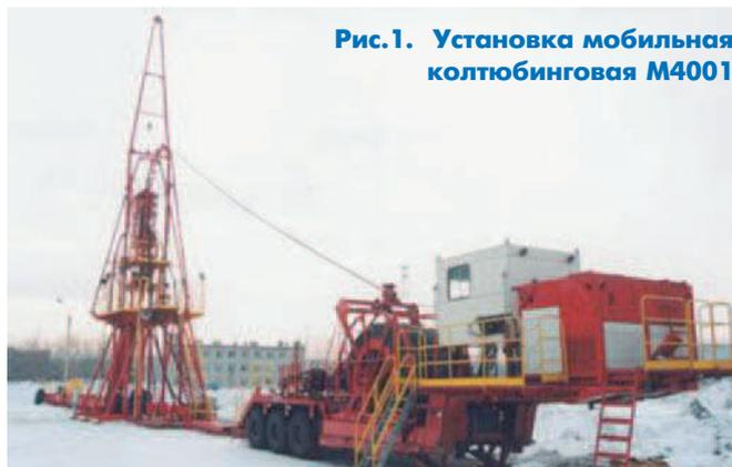
**Рис. 1. Установка мобильная колтюбинговая М4001**
