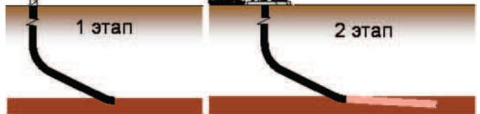
**Рис. 7. Этапы бурения с использованием гибких труб**
