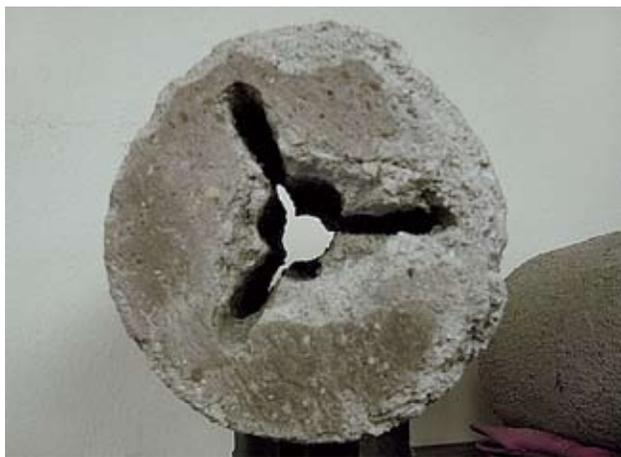
*Образцы керна после проходки устройства для радиального бурения
