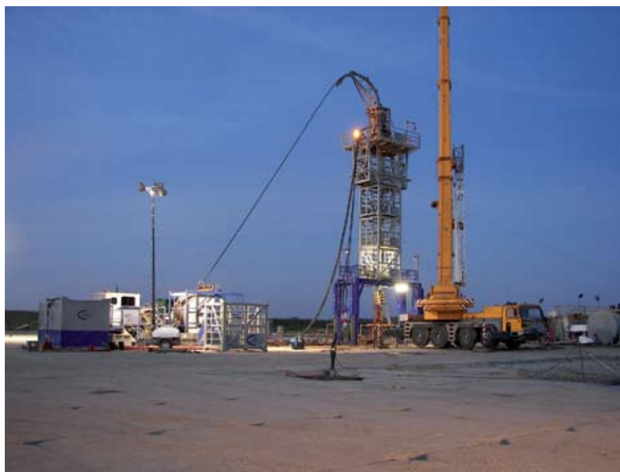
Рисунок 5 – Комплекс «колтюбинг» и дополнительное оборудование для проведения пескоструйной перфорации Figure 5 – CT complex and the additional equipment for sandblast perforation
