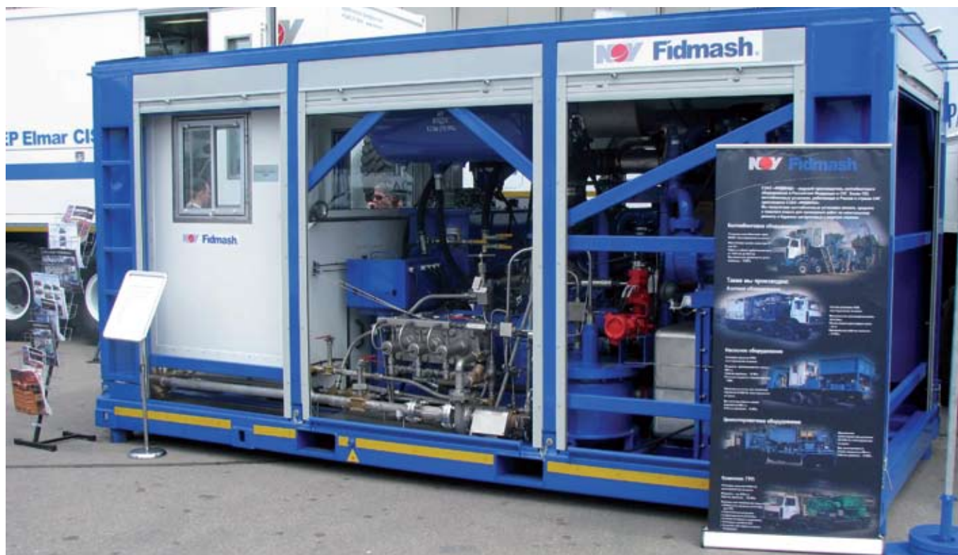
Азотная установка A100 испарительного типа A100 nitrogen vaporizing unit
