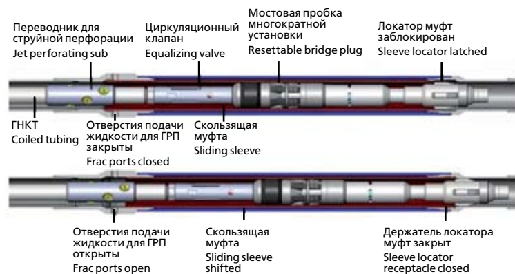
Рисунок 2 – Компоновка для ГРП и изоляции нижележащих горизонтов
