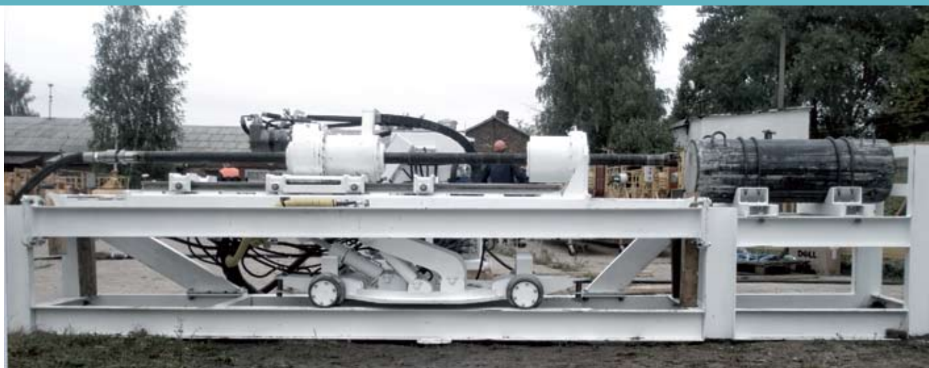
Рисунок 2 – Станок на заводских испытаниях Figure 2 – Manufacturer's trials of the drilling rig
