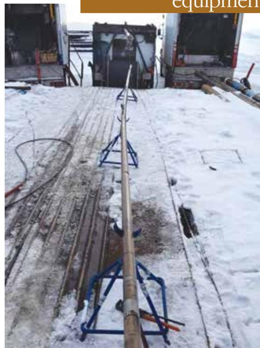
**Рисунок 2 – Забойная компоновка в процессе сборки перед спуском в скважину**
