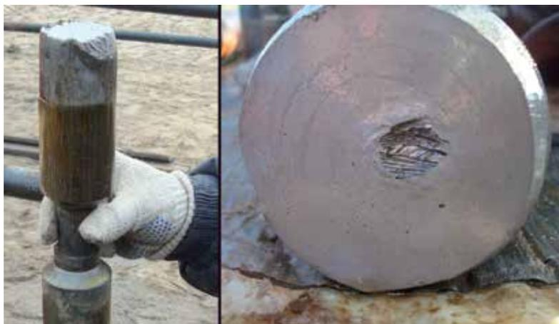
**Рисунок 2 – Сленки извлекаемого оборудования на печати**
