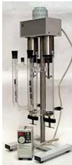
**Рисунок 3 – Переносная лаборатория по оценке эффективности ингибиторов коррозии**
