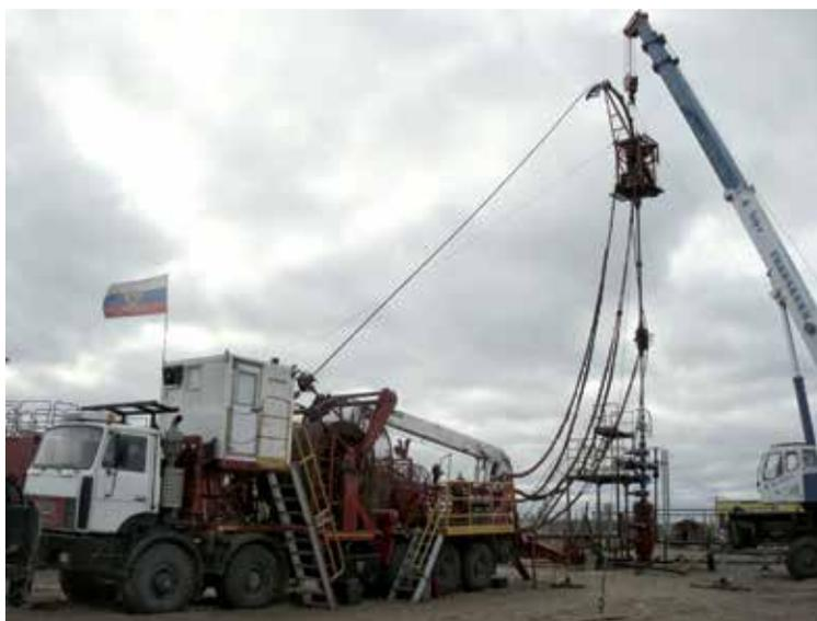
**Рисунок 1 – Ловильные работы в незаглушенной скважине с применением колтюбинговой установки МК30Т-10**
