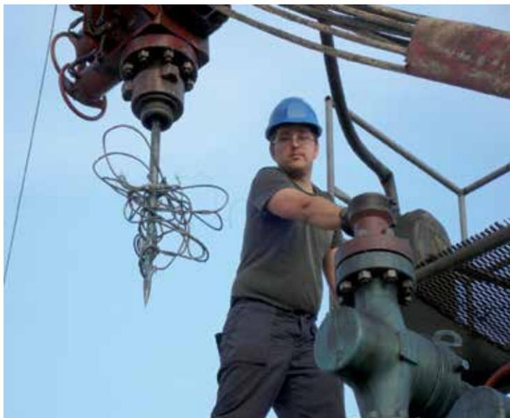
**Рисунок 3 – Извлечение геофизического кабеля**
