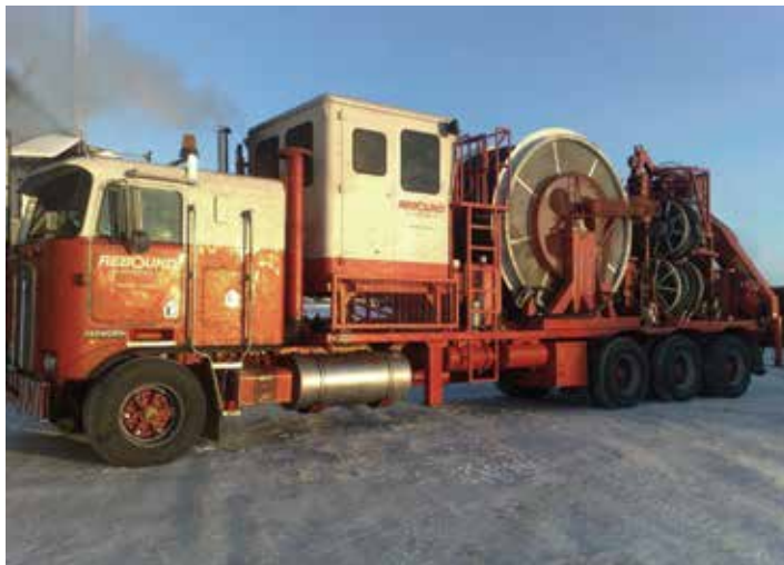
Установка Rebound перед выездом на Заполярное НГКМ для проведения ПГИ с последующей осушкой скважины Rebound unit is prepared to be transported to Zapolyarnoe oil-gas condensate field in order to perform production log tests with subsequent drying up of the well
