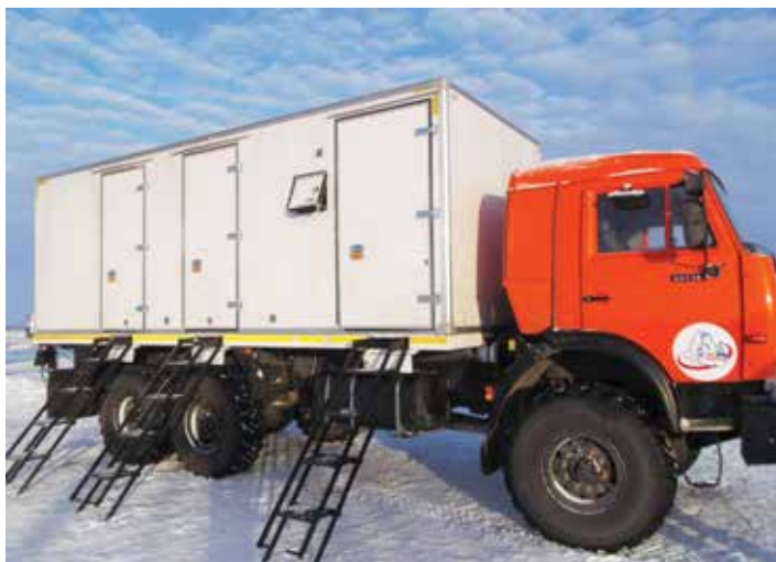
Передвижной модуль: геофизическая станция, генераторный блок, ремонтная мастерская – готовый к работе. Ямбургское НГКМ ООО «ГАЗПРОМ ДОБЫЧА ЯМБУРГ» Mobile complex consisting of geophysical station, power generator and repair bay is ready for operation. Yamburgskoe oil-gas condensate field of GAZPROM DOBYCHA YAMBURG, LLC
