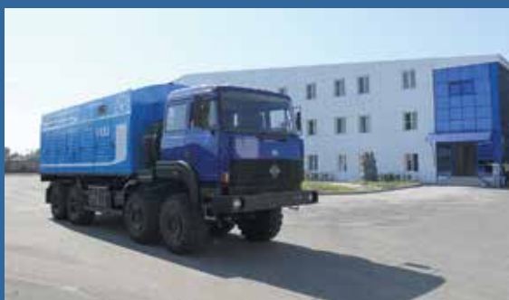
Азотно-компрессорная станция ТГА 10\251 C95 на территории Краснодарского Компрессорного Завода. Производительность – 10 м³/мин Давление – до 250 атм. изб. Чистота азота – 95%
