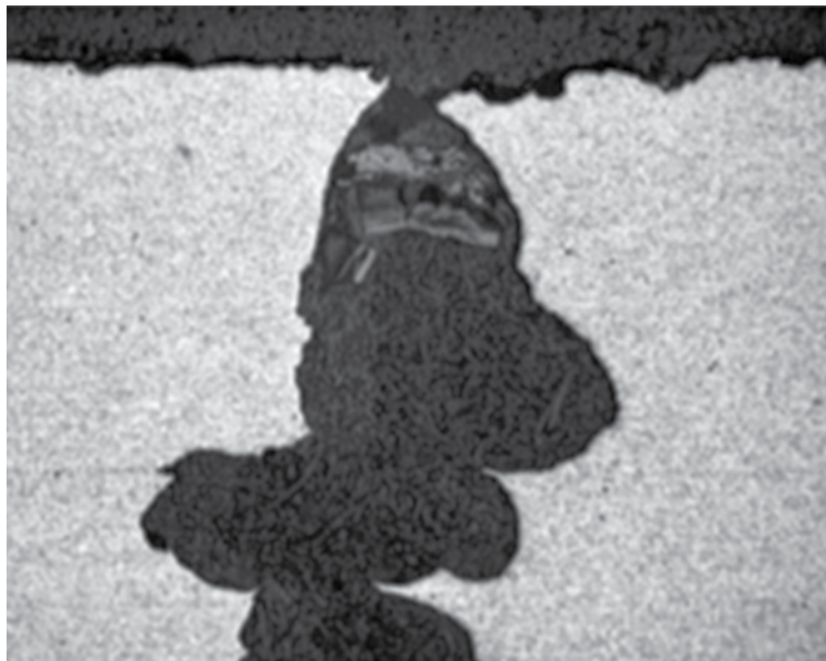
Рисунок 1 – Коррозионная язва в стальном листе, вызванная колониями бактерий Figure 1 – Corrosion Pit in Steel Plate Formed by Colonies of Bacterial Microbes
