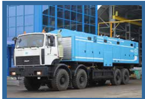
Азотно-компрессорная станция ТГА 20\251 C95 на территории Краснодарского Компрессорного Завода. Производительность – 20 м³/мин Давление – до 250 атм. изб. Чистота азота – 95%
