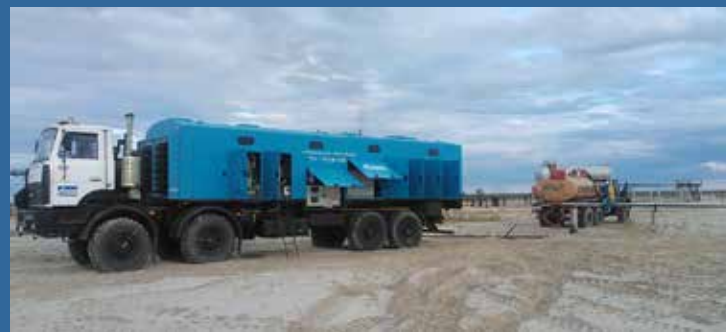
Азотно-компрессорная станция ТГА 20\251 C95 на объекте Производительность – 20 м³/мин Давление – до 250 атм. изб. Чистота азота – 95%
