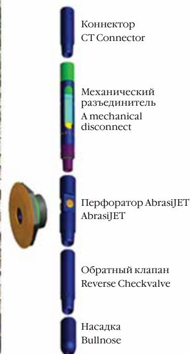
Рисунок 1 – Компоновка низа колонны (НКК). НКК состоит из внешнего коннектора (2 1/4 дюйма (57 мм), механического разъединителя (2 1/4 дюйма (54 мм)), перфоратора (2 1/8 дюйма (54 мм)), обратного клапана (2 1/8 дюйма (54 мм)) и полнопроходной насадки (2 1/8 дюйма (54 мм)).
