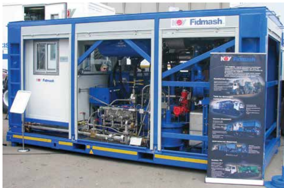
Рисунок 5 – Установка азотная А100 Figure 5 – A100 nitrogen unit
