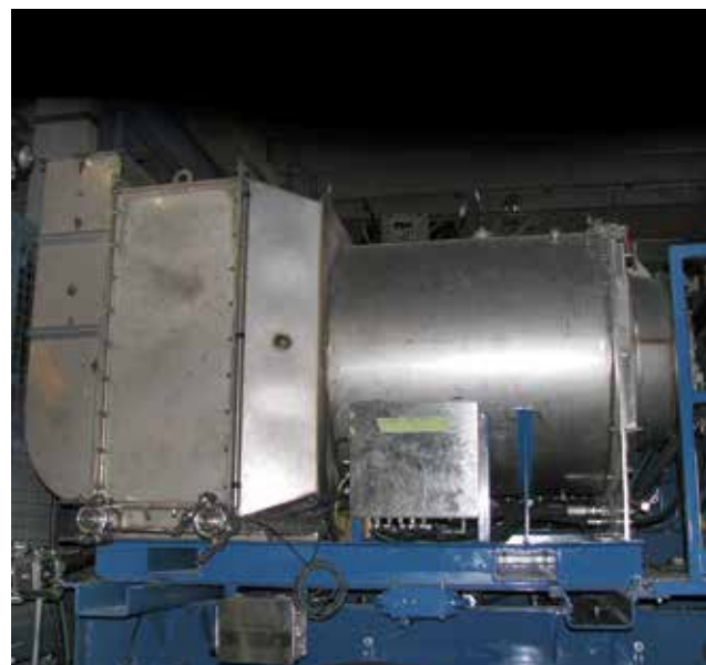
Рисунок 4 – Испаритель огневого типа Figure 4 – Direct-fired vaporizer
