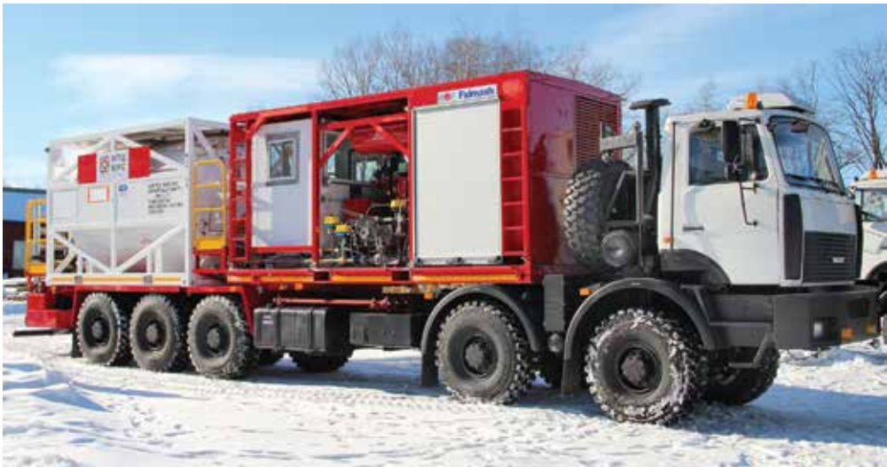
Рисунок 9 – Установка азотная на шасси МЗКТ Figure 9 – Nitrogen unit installed on MZKT chassis
