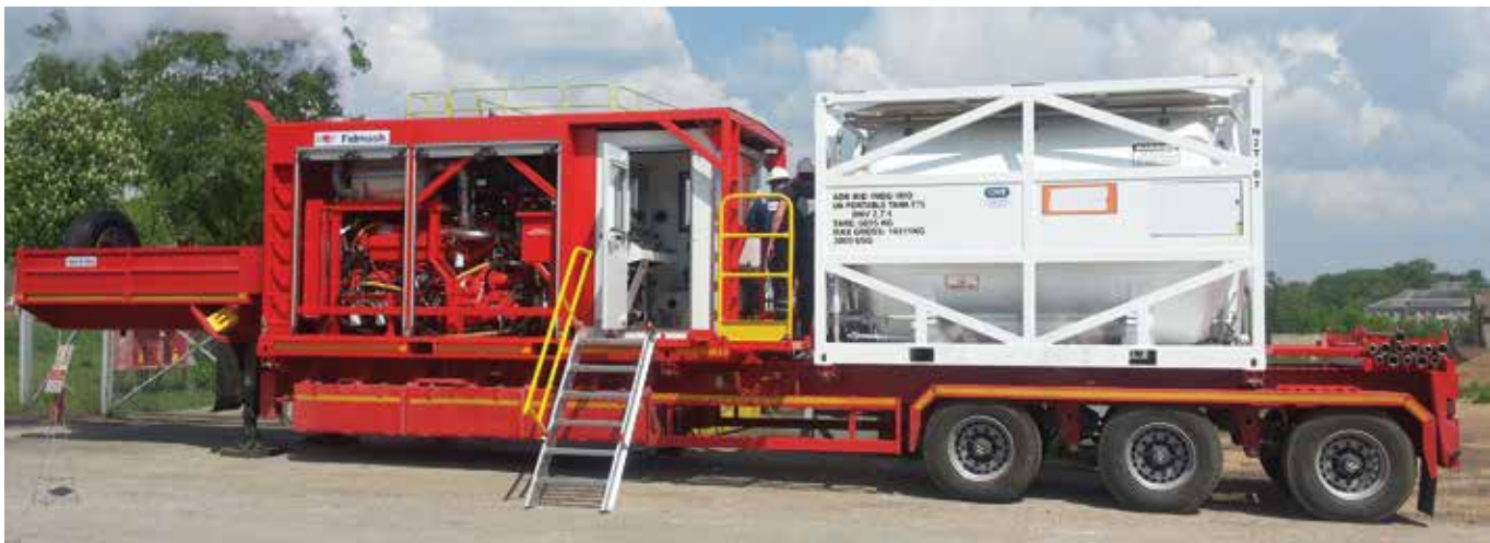
Рисунок 8 – Установка азотная на полуприцепе Figure 8 – Nitrogen unit installed on a semi-trailer
