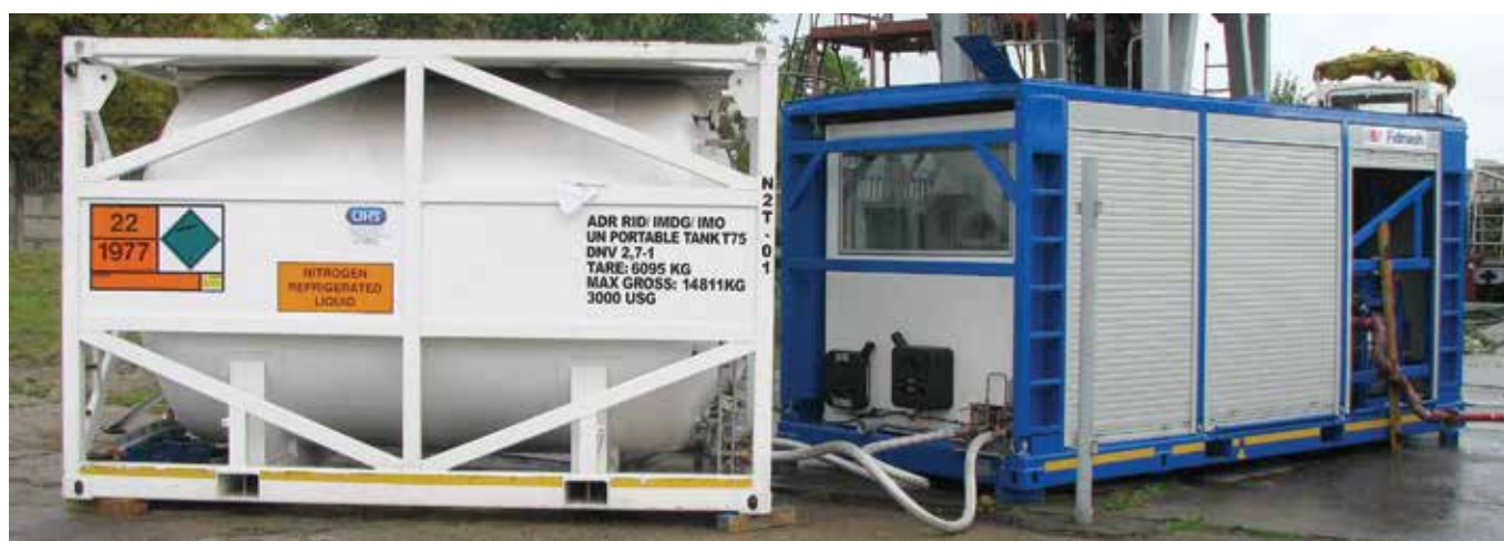
Рисунок 7 – Установка азотная в блочном исполнении Figure 7 – Modular implementation of the nitrogen unit
