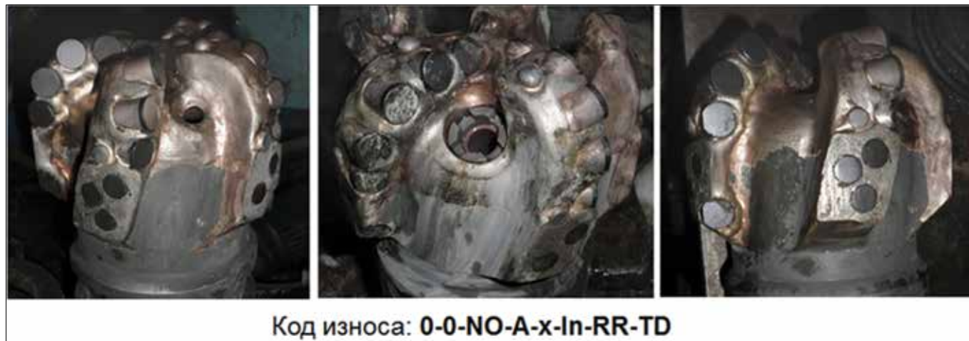
Рисунок 3 – Состояние долота BS-123,8 SD 513-001 после отработки на трех скважинах (2302 м)
