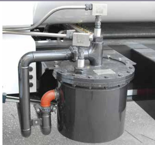
Рисунок 3 – Испаритель типа «водяная баня» Figure 3 – 'Water bath' vaporizer
