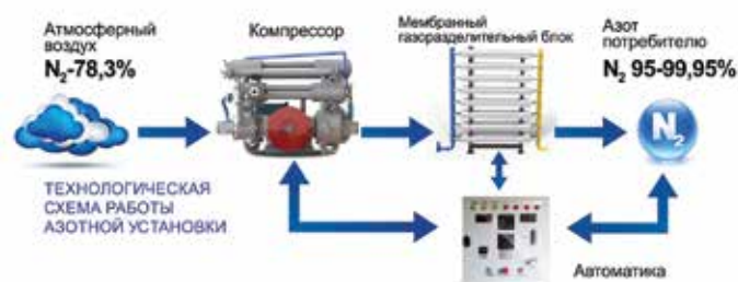
Рисунок 3 – Схема работы азотной установки ТГА
