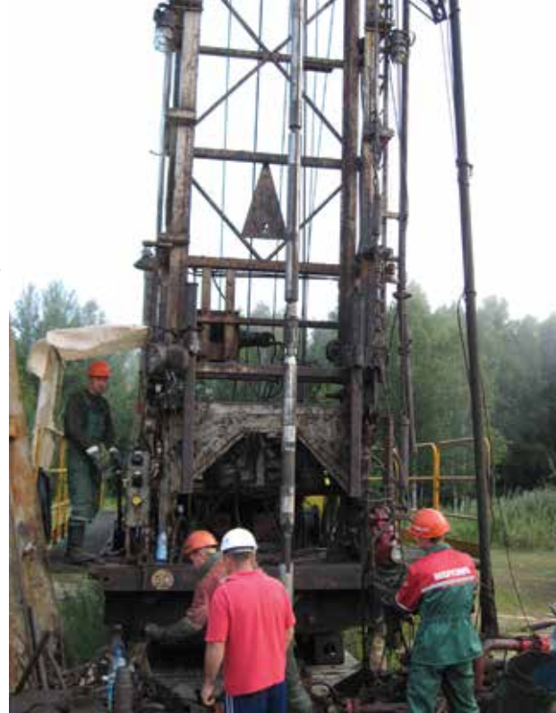
Рисунок 2 – Спускаемая компоновка внутрискважинного оборудования СК-146 Figure 2 – Variation of operating parameters of SK-146 downhole assembly during the process of drilling
