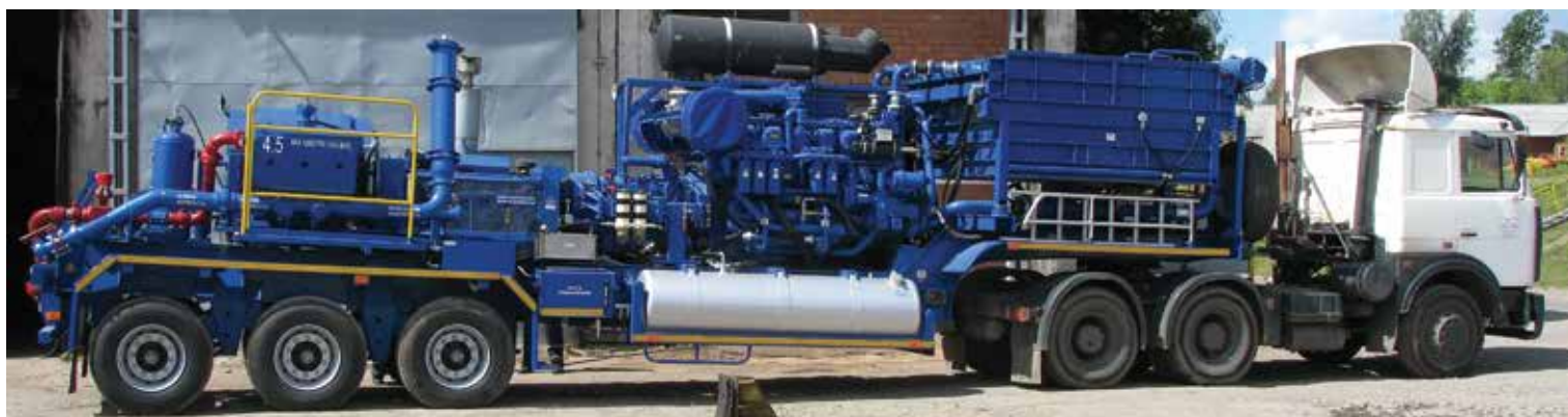
Рисунок 2 – Установка насосная H2501
