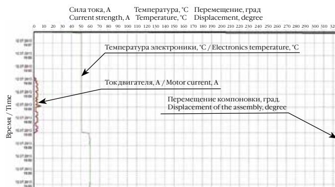
Рисунок 4 – Графики изменения параметров работы внутрискважинной компоновки СК-146 при повороте компоновки для сверления четвертого отверстия Figure 4 – Variation of operating parameters of SK-146 downhole assembly during its rotation
