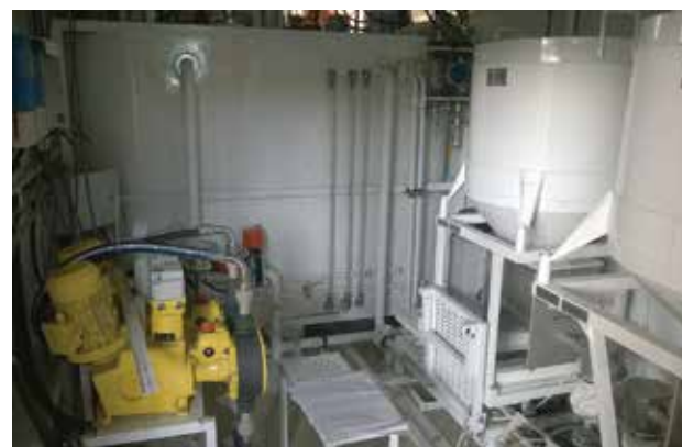
Рисунок 9 – Установка УНП9. Гидратационная емкость
