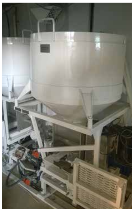
Рисунок 6 – Установка УНП9. Бункер для сыпучих химреагентов
