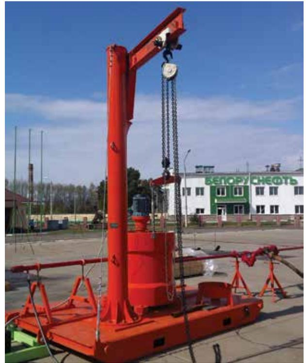
**Рисунок 2 – Кабельный инжектор производства ООО «Псковгеокабель»**
