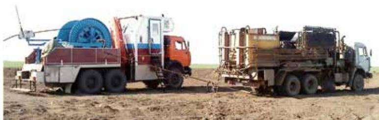
*Рисунок 2 – Освоение фонтанной скважины в Самарской области, ПКС-3,5Э с ГСПТ 38 мм. Глубина скважины 3100 м, глубина спуска ГСПТ 2150 м, рабочее давление 150 атм., отбор жидкости 65 м³ (ООО «Нефтесервис-НН»)*
