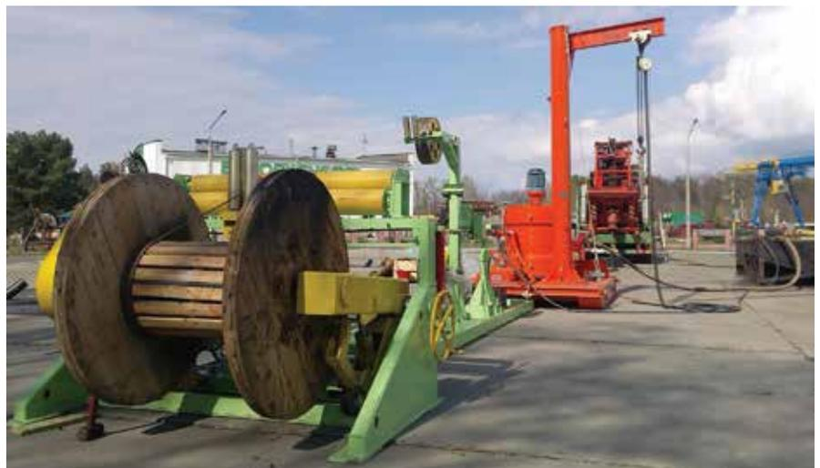
**Рисунок 3 – Комплект оборудования для оснащения ГТ геофизическим кабелем**
