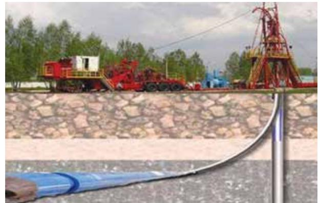
**Рисунок 3 – Комплекс для колтюбингового бурения**
