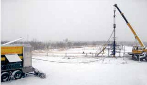
**Рисунок 3 – Удаление воды с забоя газовой скважины месторождения Комсомольское, ПКС-5Г с ГСПТ 38 мм, глубина отбора 950 м, давление в скважине 30 атм (2009 год) (ООО «ТехСервис ЗЛТ»)**
