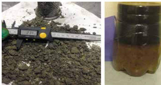
Рисунок 12 – Шлам, извлеченный из скважины шламоуловителем
