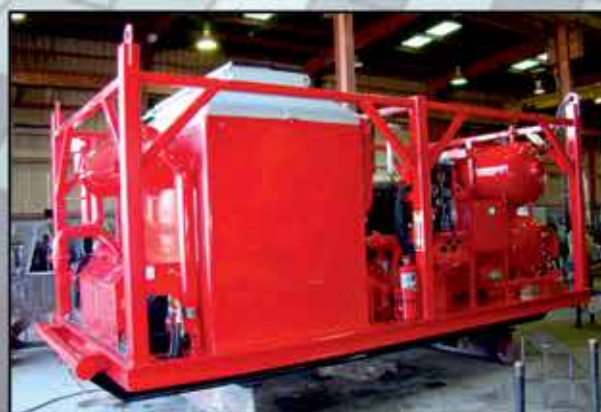
Установка подогрева контейнерного типа (3,5 МВт)
