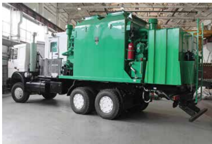
Рисунок 1 – Общий вид установки насосной подогрева УР4
