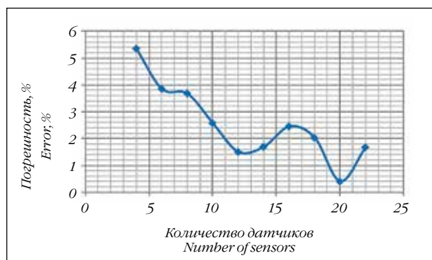
Рисунок 4 – Влияние количества датчиков давления на погрешность измерений динамического уровня
