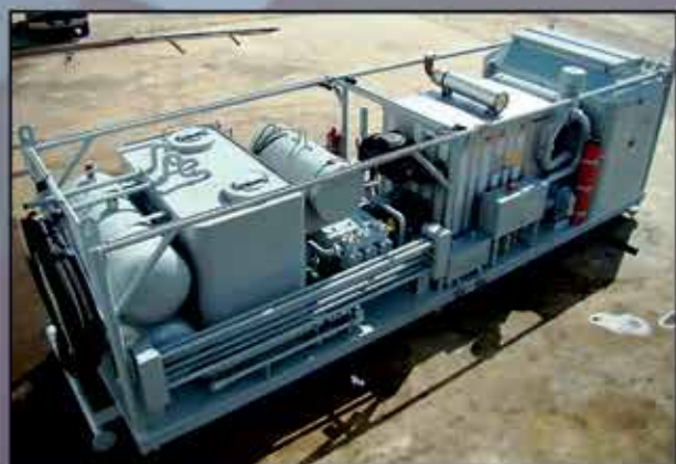
Установка насосная подогрева
