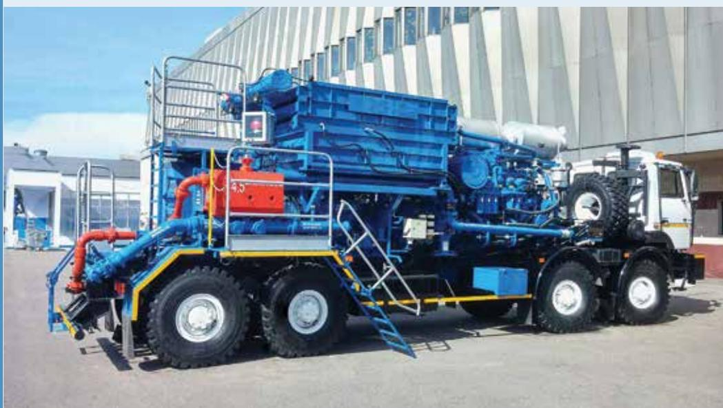
**Насосная установка H2501 предназначена для закачки различных типов жидкостей в скважину при гидроразрыве нефтяных и газовых пластов в составе комплекса, а также автономного проведения работ по промывке скважин, гидropескоструйной обработке призабойной зоны и опрессовке скважин.**
