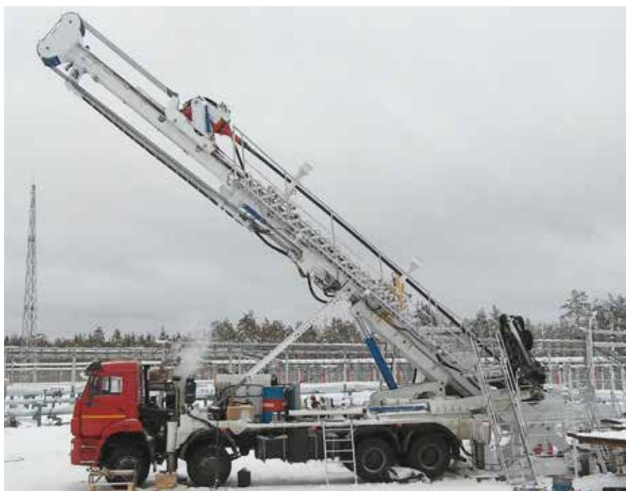
**Рисунок 1 – Установка МР50 в рабочем положении**
