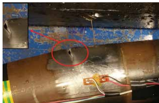
Рисунок 4 – Влияние растяжения и высокого внутреннего давления на образец
