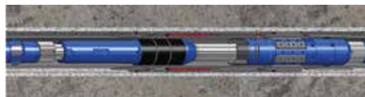
Рисунок 6 – Расположение активационного ключа для открытия/закрытия муфты ГРП
