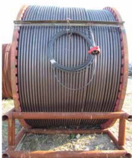
Рисунок 1 – Колтюбинг с заправленным геофизическим кабелем
