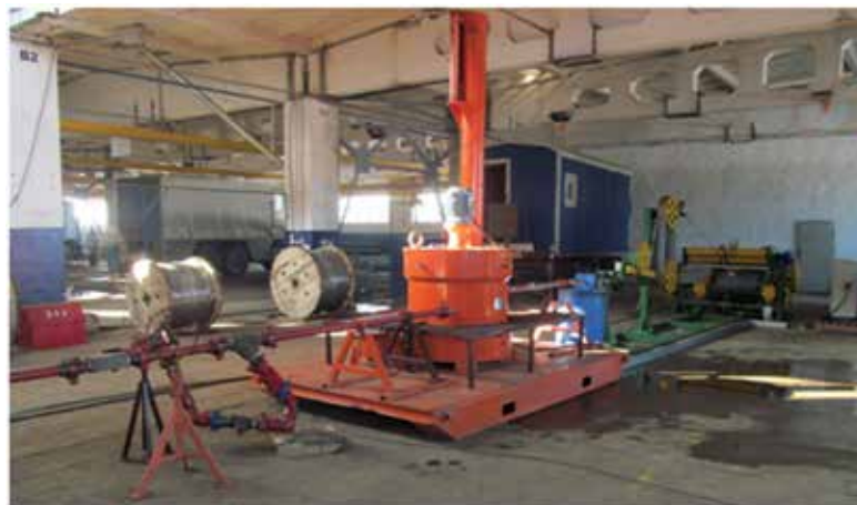
Рисунок 3 – Состав комплекта оборудования для оснащения колтюбинга геофизическим кабелем
