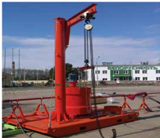
Рисунок 2 – Кабельный инжектор РУП «Производственное объединение «Белоруснефть»
