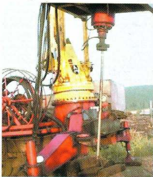
▲ Рис. 1. Внешний вид генератора типа ГД2В-2К, соединенного с гибкой трубой колтюбинговой установки М-10 Fig. 1. Appearance of GD2V-2K type oscillator connected with coiled tubing of M-10 unit.
