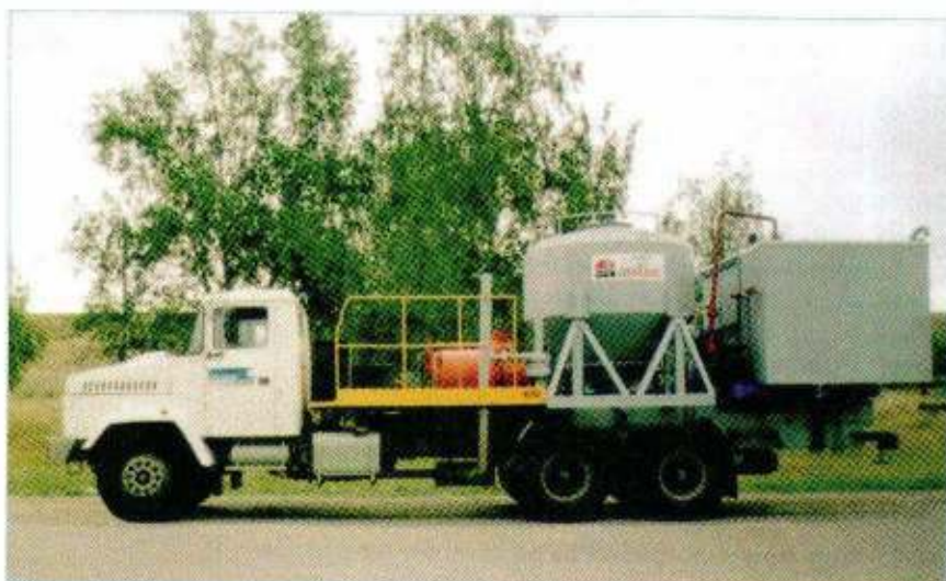
Рис. 1. Установка для производства изоляционных работ в скважинах УНЦМ-4 (общий вид)
