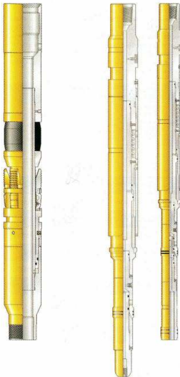
Приложение 2. Специально разработанный пакер со скоростной колонной и спусковой инструмент Appendix 2. Purpose Designed Velocity String Packer and Running Tool
