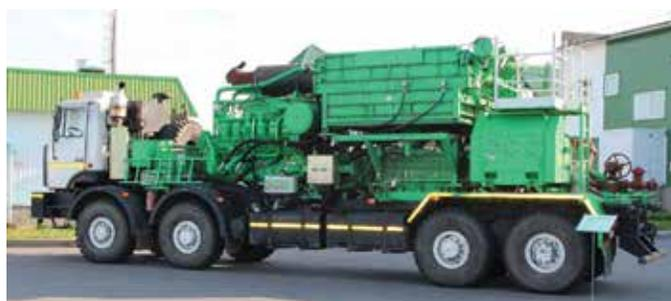
**Рисунок 2 – Установка насосная**
