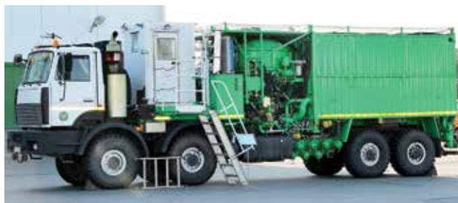
**Рисунок 6 – Установка гидратационная**
