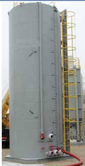
Для хранения больших объемов жидкости при проведении ГРП с большим объемом заправки оптимальным можно считать вертикальные емкости для жидкости с объемом 60 м<sup>3</sup> и утепленными стенками. Данные емкости также обеспечивают малую площадь установки при большой вместимости.
