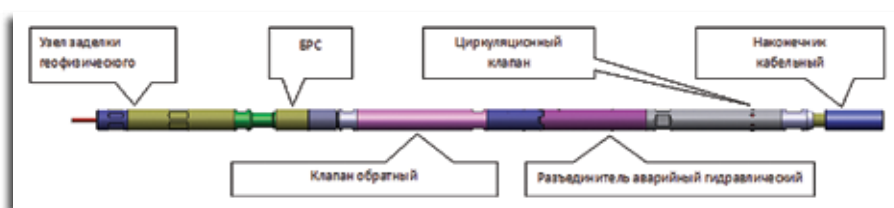
Рисунок 6 – КС171 Компоновка соединительная
