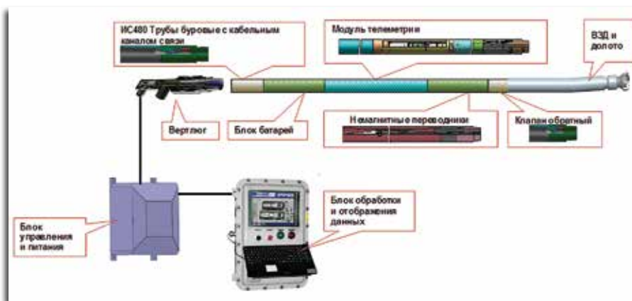
Рисунок 1 – СНБ89-73М Система направленного бурения
