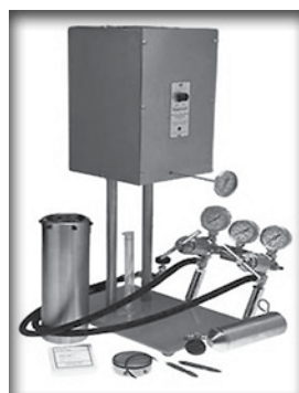
Рисунок 6 – Фильтр-пресс FANN HPHT Figure 6 – Filter press FANN HPHT
