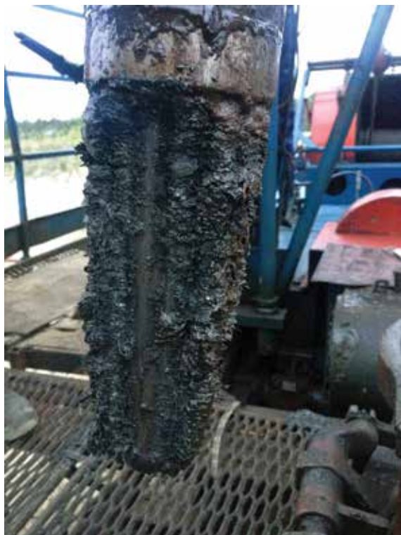
Рисунок 4 – Конус магнитный после подъема из скважины (остатки металлической стружки с внутренней стенки хвостовика)
