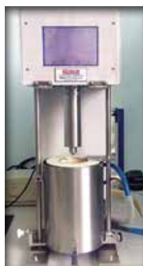
Рисунок 2 – Ротационный вискозиметр Grace M5600 Figure 2 – Rotational viscosimeter Grace M5600
