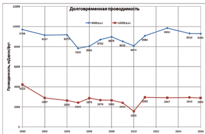
Рисунок 3 – Эволюция основных свойств пропантов BORPROP фракции 16/20 по годам выпуска
