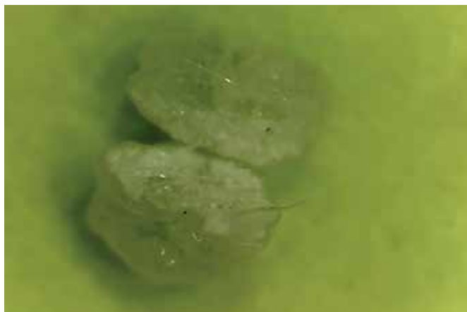
Фото промышленного инкапсулированного персульфата аммония под микроскопом Photo of commercial encapsulated ammonium persulfate, microscope view
