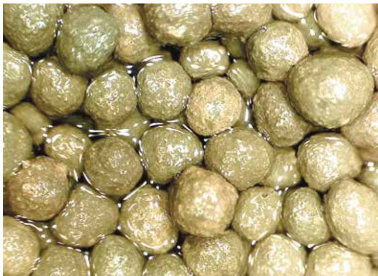
Пропантная пачка после обработки деструктором «Эконо-Тех» (82%-я остаточная проводимость)
