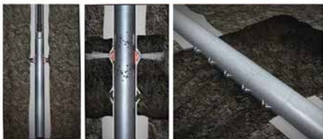
Перфорация колонны и намыв каверн
