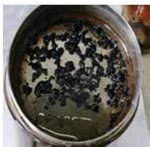
**Рисунок 3 – Осадок, полученный после пролива смеси нефти Урьевского месторождения с 24% HCl (40 °С)**
