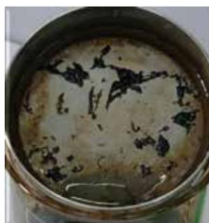
**Рисунок 5 – Осадок, полученный после пролива смеси нефти Урьевского месторождения с 24% HCl (80 °С) без катионов железа**
