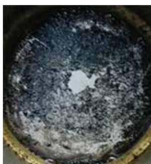
**Рисунок 2 – Осадок, полученный после пролива смеси нефти Урьевского месторождения с 24% HCl (20 °С)**
