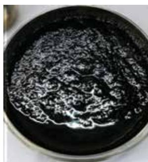
**Рисунок 6 – Осадок, полученный после пролива смеси нефти Урьевского месторождения с 24% HCl (80 °С) с катионами железа**
