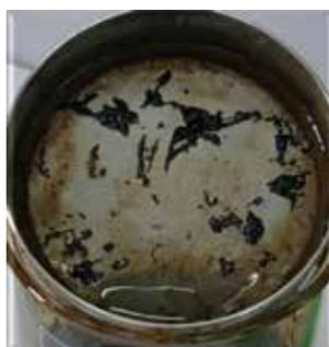
**Рисунок 4 – Осадок, полученный после пролива смеси нефти Урьевского месторождения с 24% HCl (80 °С)**
