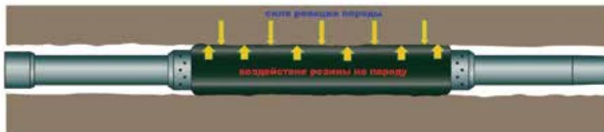
**Рисунок 3 – Работа набухающего пакера в открытом стволе скважины**
