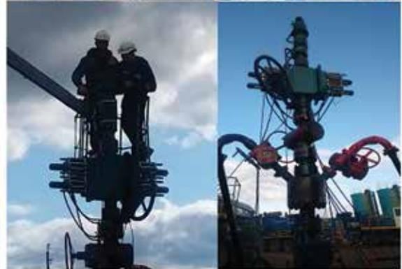
92,4 мм производства США. Для их сброса выполнялся демонтаж лубрикатора, сбрасывался шар и устанавливалась заглушка. Расчетное время начала растворения – 48 часов. Обязательным условием для реализации технологии являлось выполнение процесса ГРП с максимально точной продавкой песчаной смеси.
