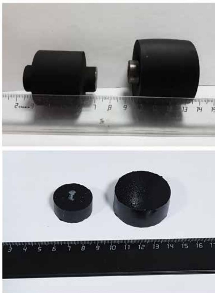
**Рисунок 5 – Лабораторные образцы резиновых смесей до и после набухания**
