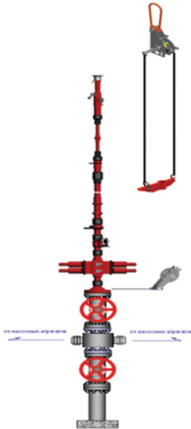
В целях обеспечения безопасного выполнения геофизических работ при посадке пакера и перфорации, доводке растворимого шара и выполнения ГРП, на устье скважины было смонтировано следующее оборудование:
