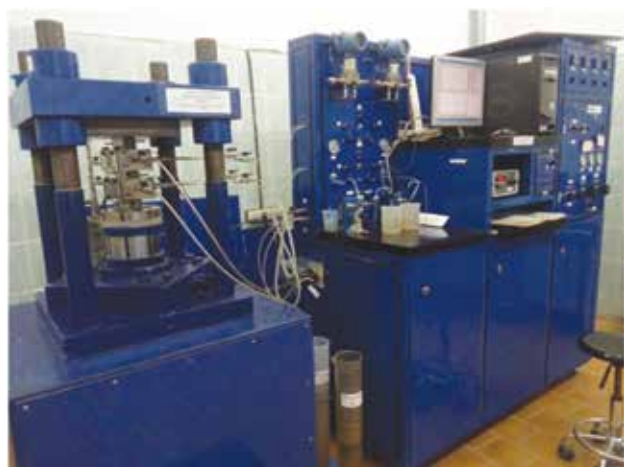
Рисунок 1 – Установка по определению проводимости и проницаемости пропантов
