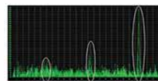
Амплитуда сигнала при определении поперечных наружных трещин.
