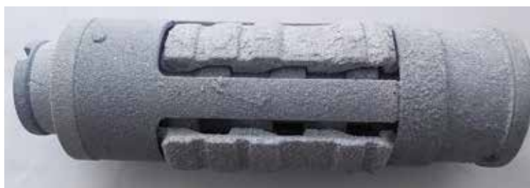
Рисунок 2 – Ключ-пробка М4 в процессе растворения
