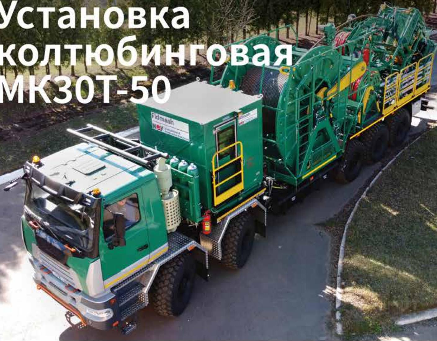
Установка колтюбинговая МК30Т (МК30Т-50) производства СЗАО «ФИДМАШ» смонтирована на полноприводном шасси (10х10) и представляет собой полный комплект оборудования для работы с безмуфтовой длинномерной трубой (БДТ). Предназначена для БДТ диаметром 44,45 мм, но может также работать с БДТ диаметром 50,8 мм. Зимний пакет и кондиционеры в обеих кабинах.
