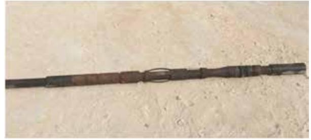
**Рисунок 7 – Верхняя компоновка лифтовой колонны**
