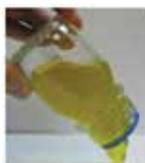
**БСВ** – гели на полимерной основе, применяются в скважинах с высоким газовым фактором и высоким показателем проницаемости.
