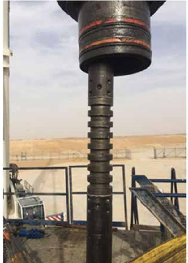
**Рисунок 8 – Двойной коннектор для соединения и намотки труб**
