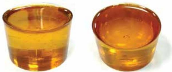
**Рисунок 1 – Образцы камней на основе эпоксидно-диановой смолы**
