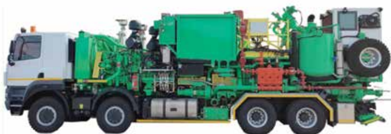
Цементировочная установка УНС-12
