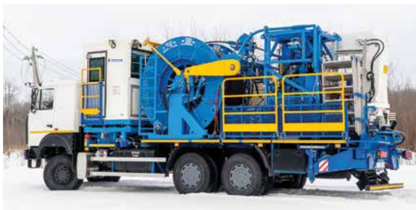
Установка непрерывной трубы УНТ-1
