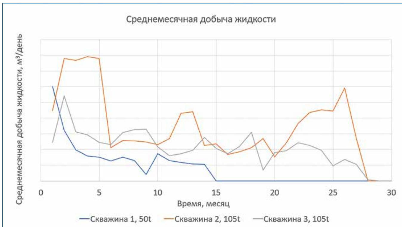
**Рисунок 8 – Добыча жидкости со скважин ачимовской толщи**
